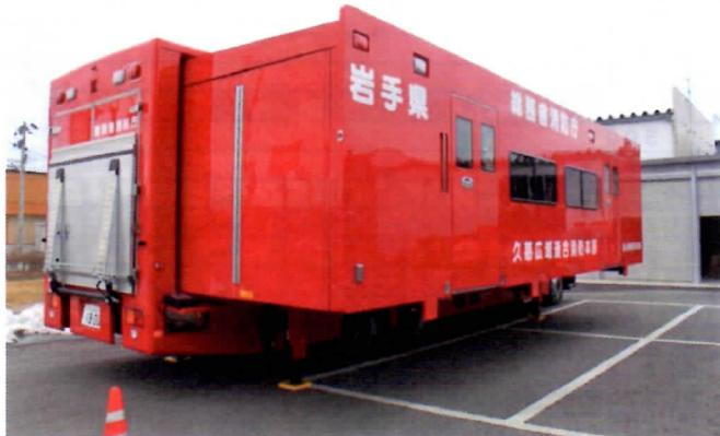
車幅2,490mmで、荷室が右側に幅2,100mmせり出し、拡幅総幅は約4.6mとなり、約40m<sup>3</sup>の室内空間を確保します。
