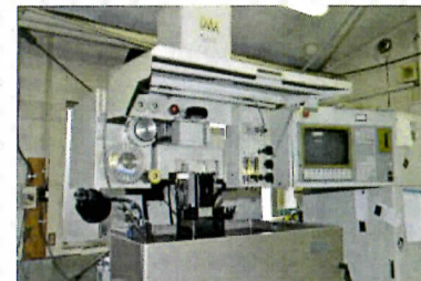
ワイヤカット放電加工機/DIAX 10SX テーブル作業面/590×514mm 移動エリア/350×250×200mm
