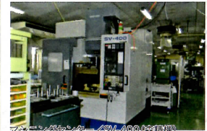
マシニングセンター/SV-400(森精機) テーブル作業面/900×500mm 移動エリア/600×460×430mm 主軸回転速度/20,000rpm エアースト/40,000rpm 送り速度/20,000mm/min
