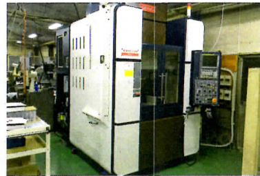
マシニングセンター/YMC-430(安田工業) 移動エリア/420 x 300 x 250mm 主軸回転速度/40,000rpm 送り速度/20,000mm/min
