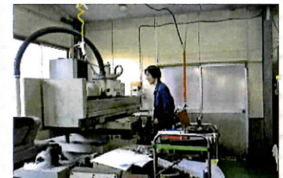
研削盤/63DX(岡本) ベッド寸法/600×300mm 移動エリア/600×300mm 送り速度/MAC70P(浜井産業)
