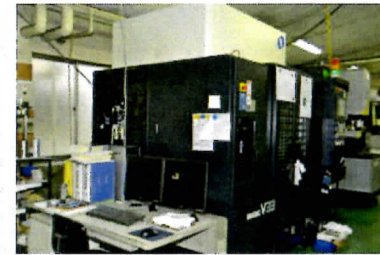
マシニングセンター/V33(牧野フライス) テーブル作業面/750×400mm 移動エリア/650×550×350mm 主軸回転速度/30,000rpm 送り速度/20,000mm/min
