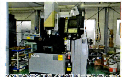
NC形鋼放電加工機/A085L(リネックス) テーブル作業面/600×400mm 加工タンク内/750×550×320mm 各軸ストローク/350×250×250mm 電極取付面とテーブル/212~462mm 放電加工機 他2台 A5CR、A3CR
