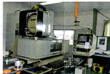
マシニングセンター/3VA(浜井産業) テーブル作業面/1100×460mm 移動エリア/650×450×450mm
